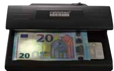
Das Wasserzeichen wird durch das Weißlicht erkennbar (nur Soldi 185)
